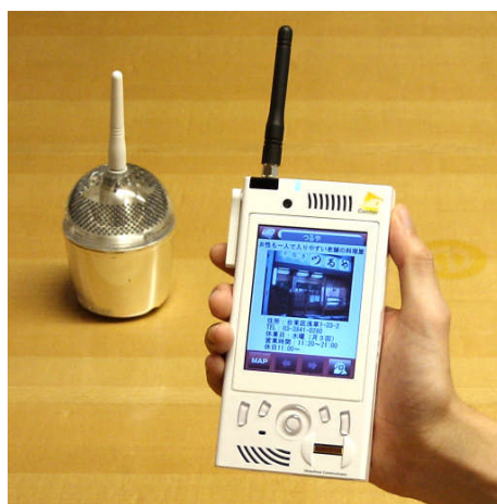
図3 モバイル型 Dice 基地局 奥は太陽電池付き Dice 電波マーカ
